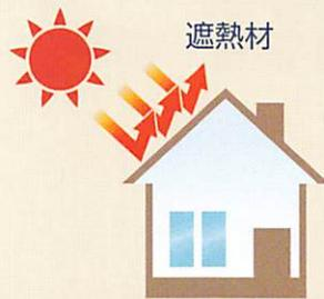
遮熱材は、断熱材よりも薄く(シート状)、表面のアルミ箔によって輻射熱を反射(遮断)します。夏は外部からの暑い熱を反射(遮断)し、室内を快適に保ちます。
