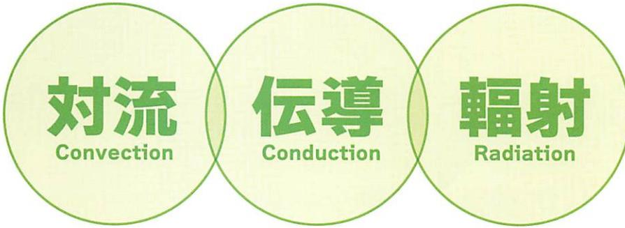
熱移動には、「対流熱」「伝導熱」「輻射熱」の3種類があり、「輻射熱」が建物全体の移動熱量の約70%を占めています。
